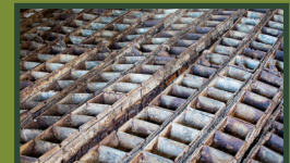
Mouleaux de la glacière de Palisse permettant la constitution des pains de glace
